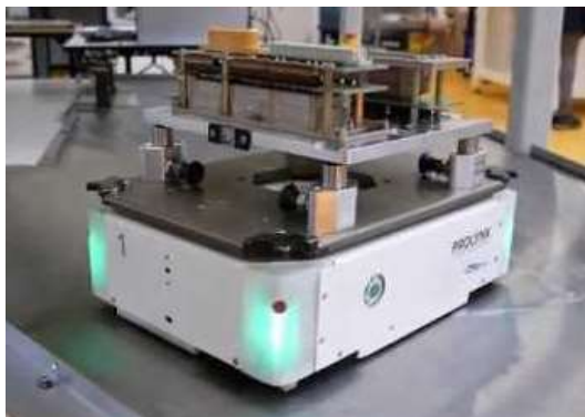
OSE GROUP : Solution PROLYNK de Mini AGV circulant sur un plan de travail pour transporter les produits à assembler
